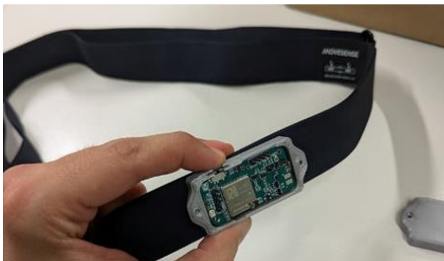
Obr.3: Konstrukce systému a upevnění na pás s neadhezivní EKG elektrodami
