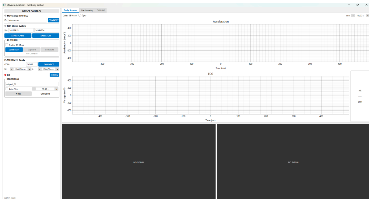
Obr. 1: Hlavní okno aplikace (záložka Body Sensors). Rozhraní je rozděleno do tří logických bloků: (1) Levý ovládací panel "Device Control", (2) Grafická část pro vizualizaci zrychlení a EKG, (3) Spodní část pro náhled kamer.
