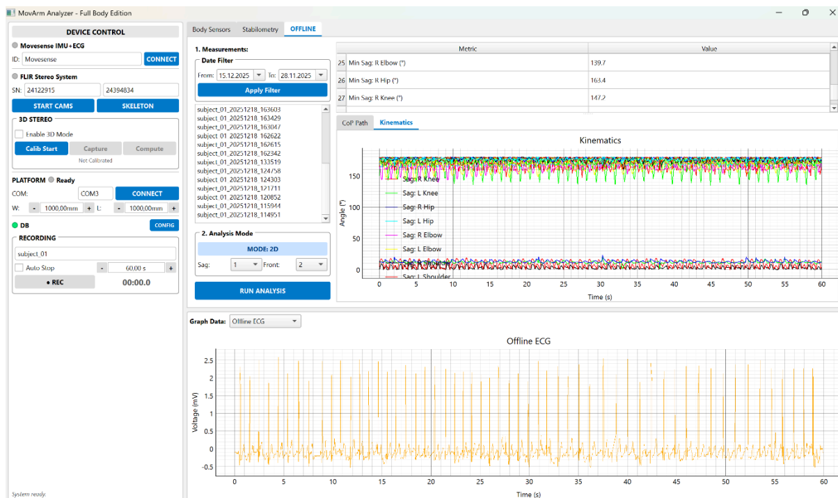
Obr. 19: Offline analýza Kinematika a EKG. Horní graf zobrazuje průběhy úhlů v kloubech (barevné křivky), spodní graf detailní záznam EKG
