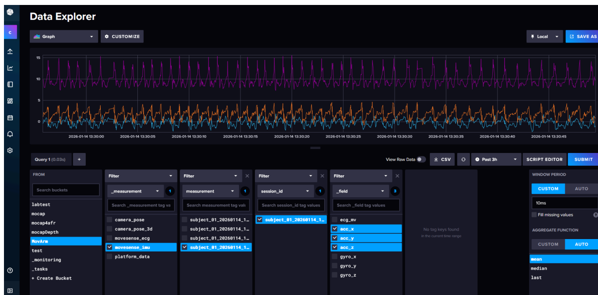
Obr. 12: Rozhraní InfluxDB Data Explorer. Slouží k detailnímu dotazování nad daty. V dolní části (Query Builder) se vybírají konkrétní senzory a veličiny. Tlačítko CSV slouží k exportu dat do souboru.
