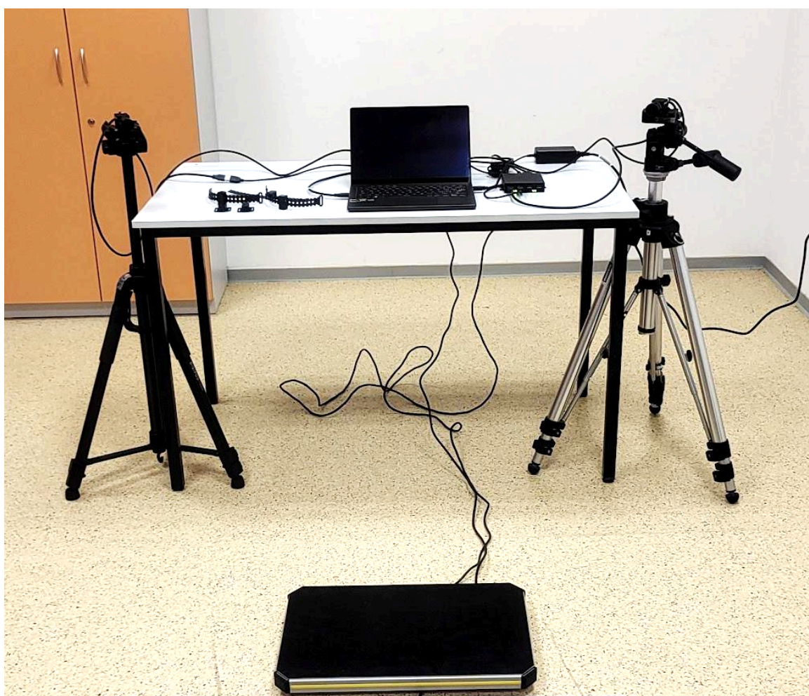
Obr. 2: V praxi otestovaný prototyp Přenosného modulárního systému MoCap pro záznam a vyhodnocování stavu příslušníků armády a záchranářů.
