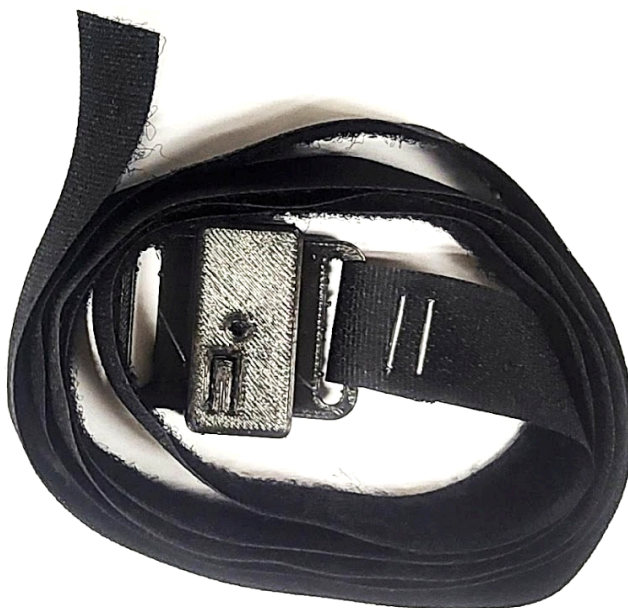
Obr. 12: Senzor MoCap4AFR-MoCap v krabičce s popruhem kolem pasu.
