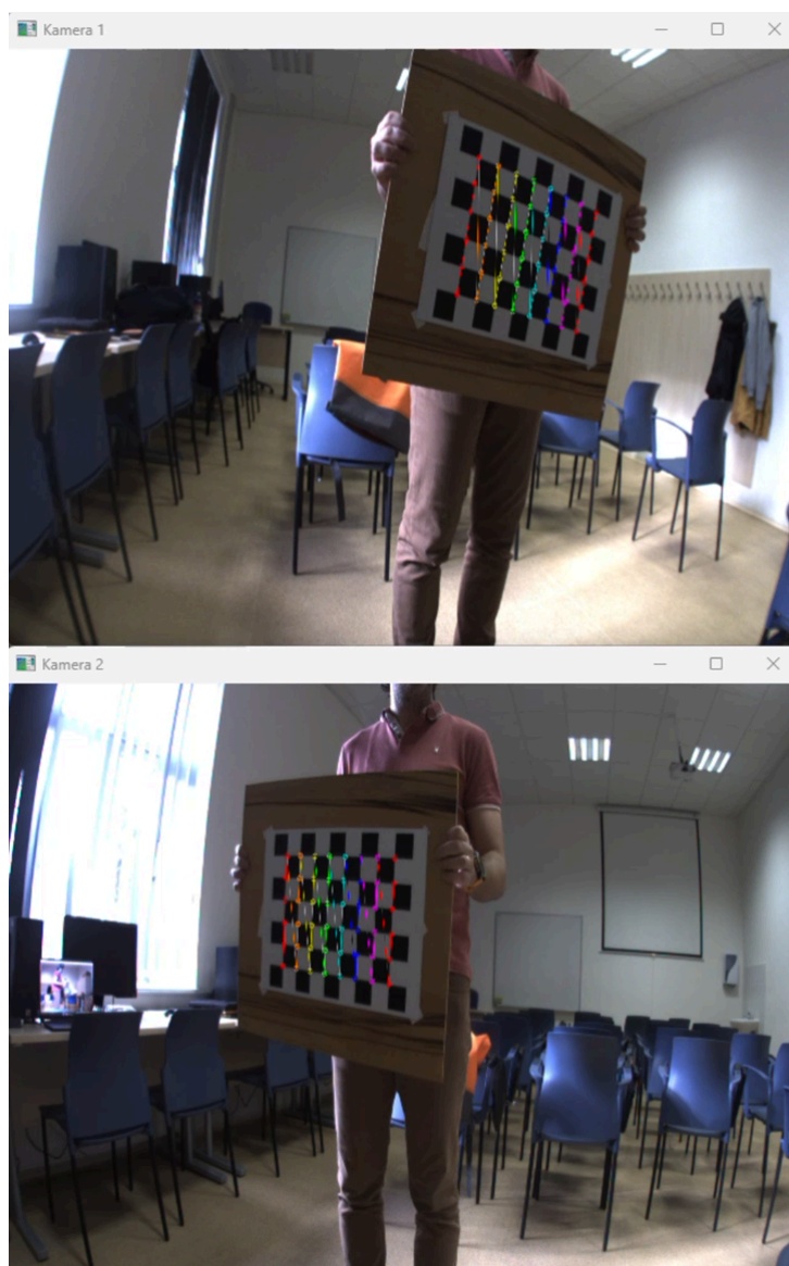
Obr. 23: Ukázka synchronizovaného snímání kalibračních snímků
