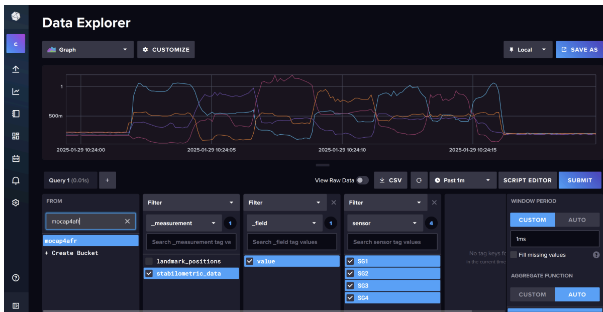
Obr. 39: Záznam tenzometrického senzoru do InfluxDB v SW pro záznam a zpracování pohybových dat ze stabilometrických plošin
