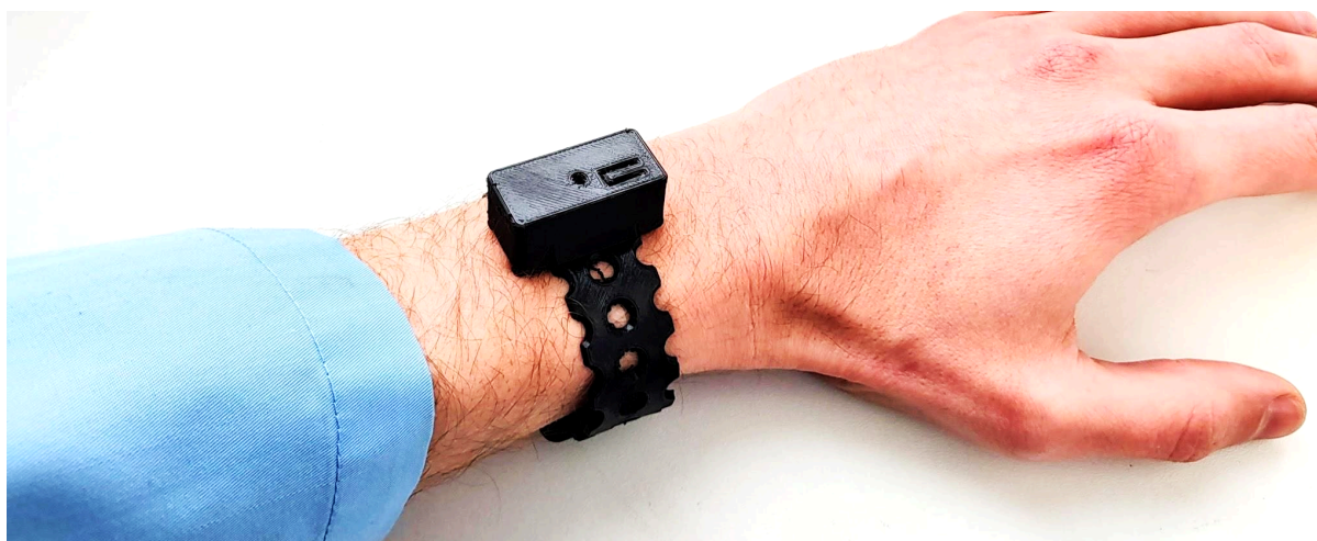
Obr. 3: Zkonstruovaný prototyp MoCap4AFR-MoCap senzoru absolutní orientace v prostoru v 3D tištěné krabičce z flexibilního filamentu.
