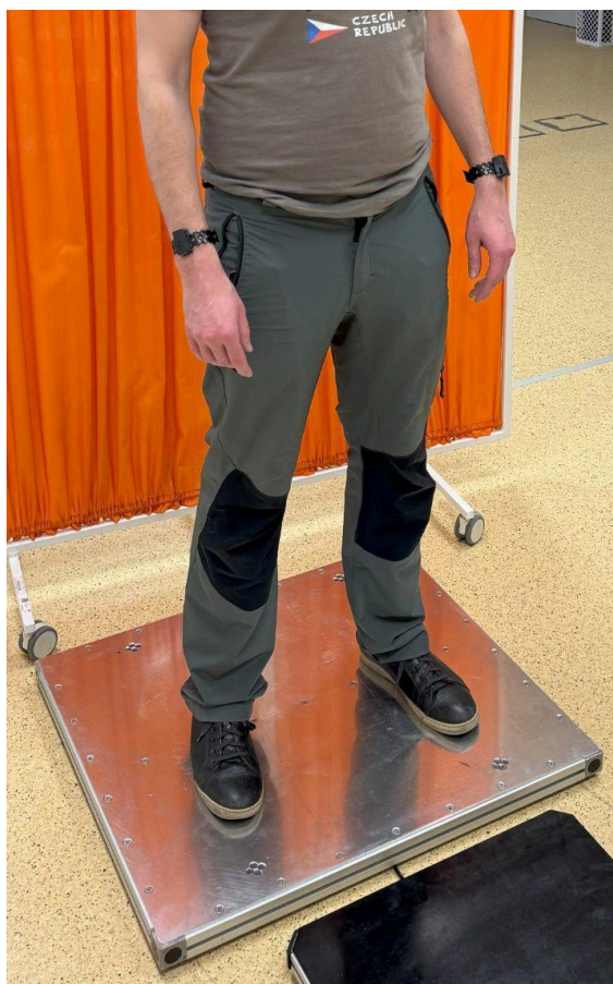
Obr. 27: Realizovaný prototyp siloměrné plošiny
