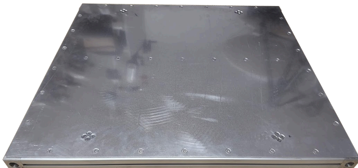
Obr. 31: Siloměrná plošina o rozměrech 700 x 800
