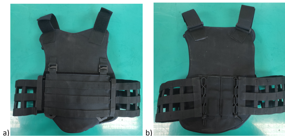
Obr.3.: Sestava plátů v nosiči a) pohled zepředu, b) pohled zezadu
