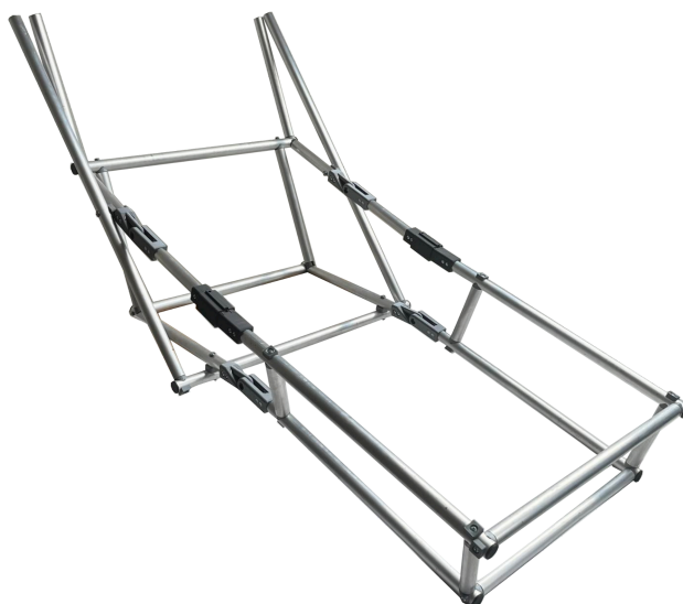
Obr. 1: 3D model skládacího rámu funkčního vzoru vozíku
