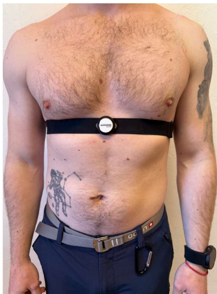
Obr.3 Ukázka realizace a upevnění nositelného systému pro měření fyziologických a pohybových dat
