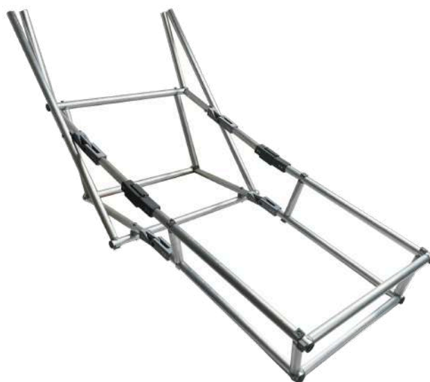
Obr. 1: 3D model skládacího rámu funkčního vzorku vozíku
