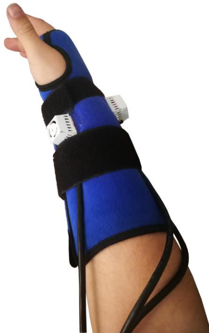
Obr. 11: Správné umístění ruční ortézy s implementovaným systémem a 3 moduly termočlánků.
