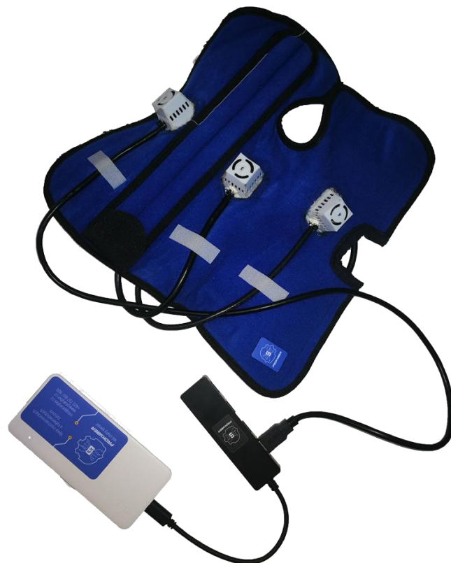
Obr. 5: Názorná ukázka aplikace systému do ortézy pro chlazení ruky (fixaci zápěstí). V obrázku je vyobrazena miniaturní verze systému určená pro domácí použití pacienty. Černá krabička – řídicí jednotka je propojena s jednotlivými moduly termočlánků a s bílou krabičkou – balíkem akumulátorů napájejících řídicí jednotku a moduly termočlánků.
