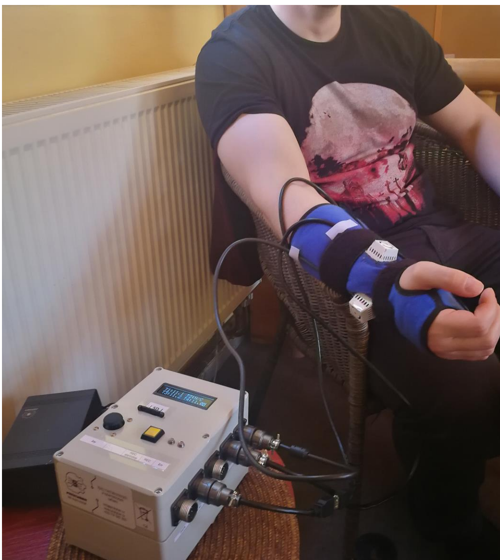
Obr. 13: Příkladná aplikace na pacientu v odpočinkové místnosti. Profesionální verze umožňuje intuitivní nastavení pomocí LCD. Vhodně zvolené parametry jsou ihned testovány a pokud je pacient s výsledným chladicím efektem spokojen jsou exportovány do konfiguračního souboru pro domácí verzi zařízení.
