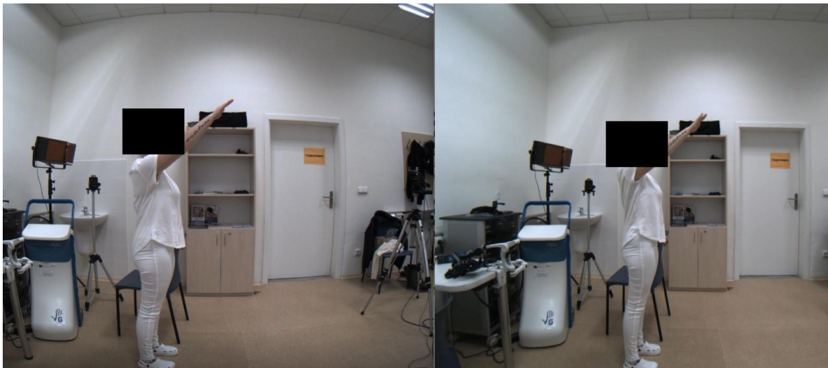
Obr. 1 Softwarová korekce optické vady snímání soustavy (vlevo před korekcí, vpravo po korekci)
