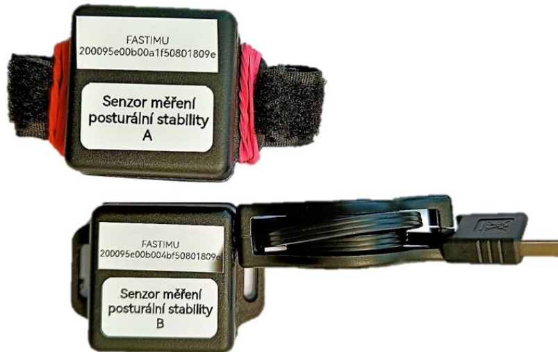
Obr. 32. Zkonstruované gyroakcelerometrické senzory: Senzor pro měření posturální stability A a Senzor pro měření posturální stability B.
