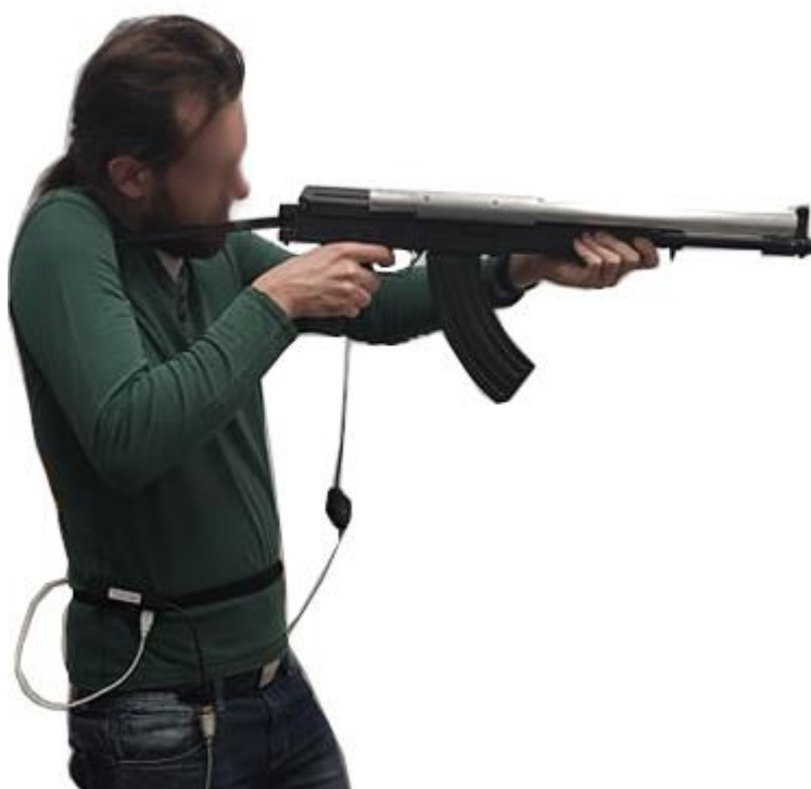
Obr. 37. Ukázka zapojení celé soustavy pro měření posturální soustavy a chování střelce a zbraně během střelby.
