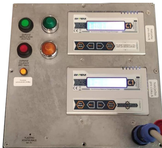
Obr. 23. Víko přístrojové skříně ovladače cívek. Zelený přepínač slouží k zapnutí mikroprocesoru (MCU) a zelená kontrolka signalizuje správné nabootování MCU. Červený přepínač slouží k zapnutí výkonové části, tedy aktivování řízení cívek pomocí MCU. V krytu jsou umístěny 2 ovládací panely obvodů pro kontrolu aktuálního stavu akumulátorů, řízení jejich nabíjení a diagnostiku stavu akumulátorů. Červená krytka schovává konektor pro připojení napájecího napětí pro nabíjení akumulátorů. Hmotnost přístrojové skříně je 4,2 kg s akumulátory bez připojených přívodních vodičů k cívkám.
