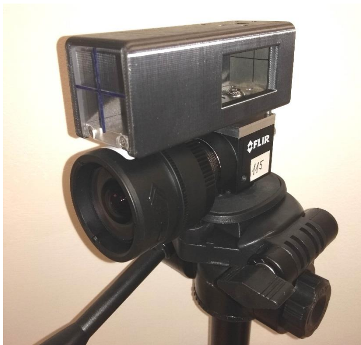
Obr. 2: Kamera vybavená vyvinutým kolimátorem.
